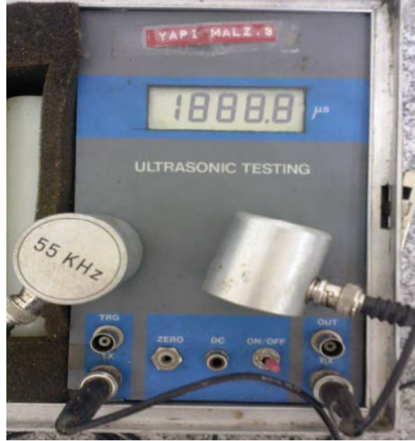
Şekil 3.5 : Ultrases ölçümlerinin yapıldığı cihaz
