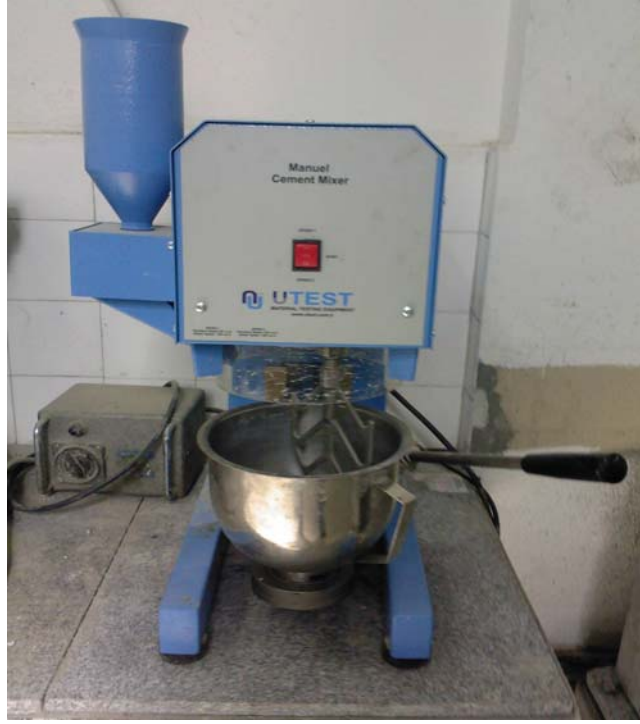
Şekil 3.2 : Üretimlerin yapıldığı iki hızlı karıştırıcı.
