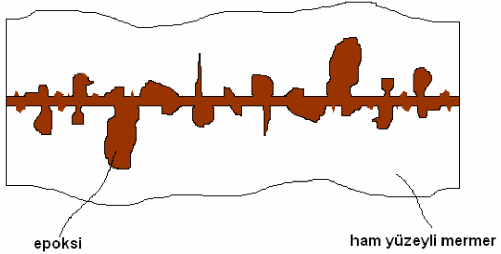
Şekil 6.1: Yapıştırılmış ham yüzeylerin kesit görünümü
