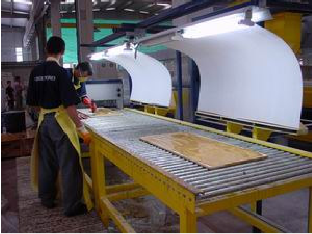
Şekil 4.1: Epoksinin spatula ile yüzeye uygulanması
