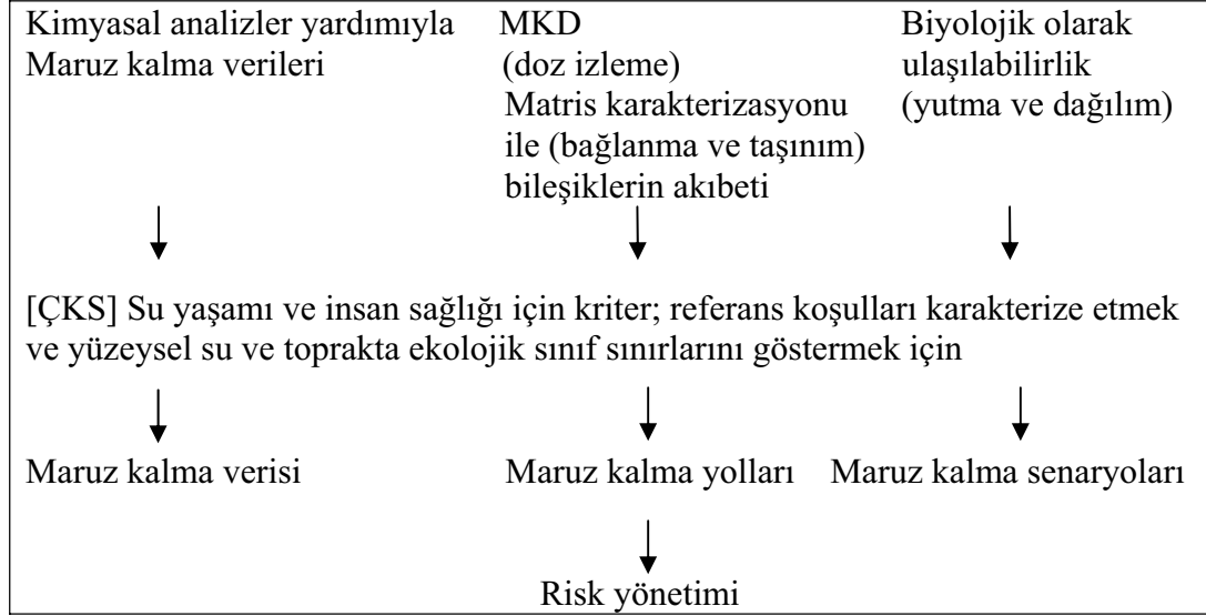
Çizelge 2.2: Maruz Kalma Değerlendirmesi (MKD) – Su, toprak ve insan sağlığı için çevresel risk değerlendirme (ÇRD) stratejileri – maruz kalma değerlendirmesinden risk yönetimine (Hansen, 2007).
