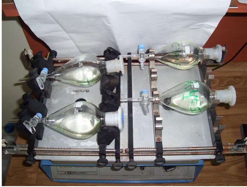
Şekil 5.1. Deneylerde Kullanılan HS 500 Çalkalayıcı
