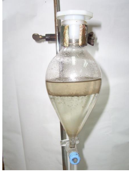
Şekil 6.4. AgNO 3 ile yükleme sırasında bozulan TBP
