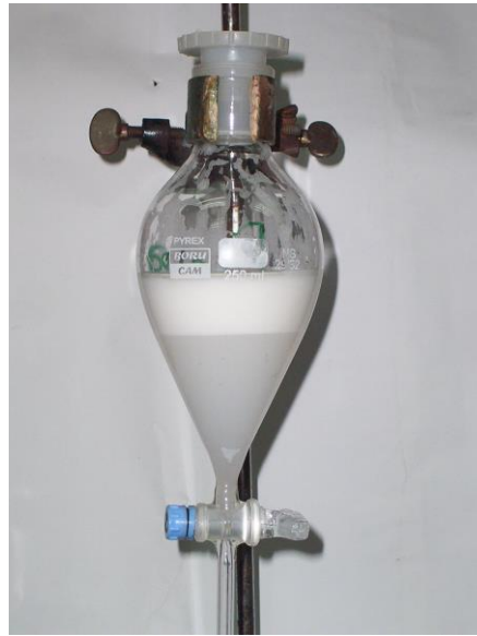
Şekil 6.27. KCN ile sıyırma sırasında bozulan Ag^+ yüklü Ionquest 801
