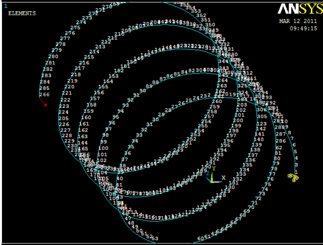
Şekil 4.2 : ANSYS programında kullanılan bir model ( \theta = 9\pi , \alpha = 5 ).
