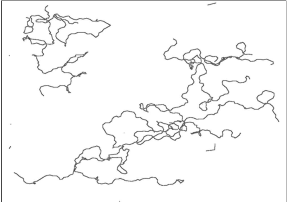
Şekil 6.1c: Sistem tek bir zincir olana dek simülasyon sürdürülebilir. Yukarıdaki son resim simülasyon durdurulmadan hemen önce alınmıştır. Resimler sistemin 2 boyuta izdüşümüdür.
