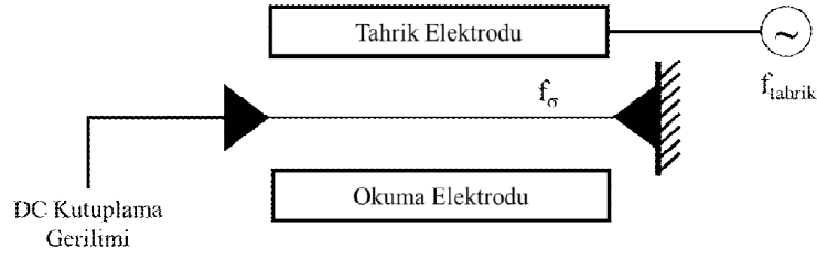
Şekil 9. Nanotel çınlaç sisteminin çalışma ortamının şematik gösterimi.
