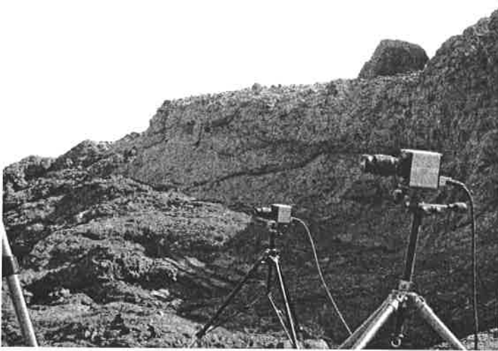
Şekil 10 : 3 Boyutlu Hareket ve Deformasyon Analizi Yapmak Üzere Yerleştirilen Hızlı Kameralar
