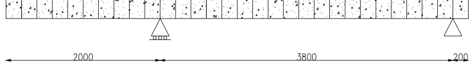
Şekil 4.1: Kirişin sonlu eleman modeli
