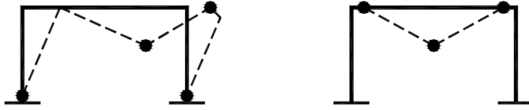
Şekil 2.19: Tümsel ve Bölgesel Mekanizma Durumları
