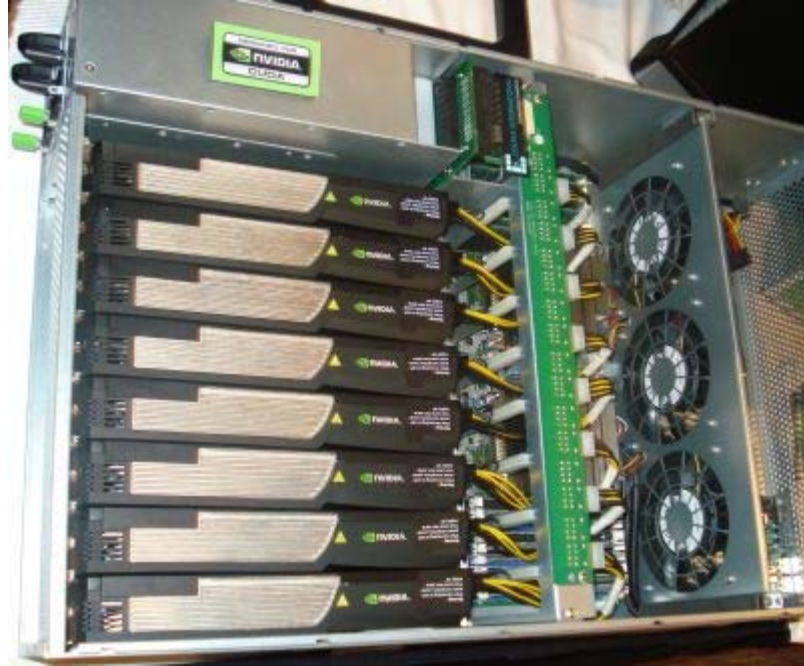
Şekil 5.3: NVIDIA Tesla kartlar içeren bir masaüstü süper bilgisayar
