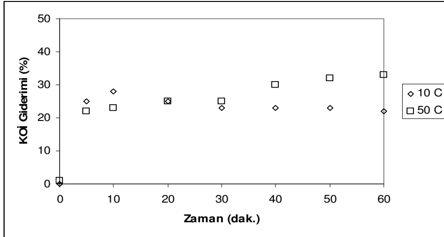
Şekil 4.17: Farklı Sıcaklıklarda KOİ Giderim Verimi ( Fe^{2+}_0 = 6 \text{ mM} , H_2O_{2,0} = 30 \text{ mM} , t=60 \text{ dak} , KOİ_0 = 2688 \text{ mg/L} )
