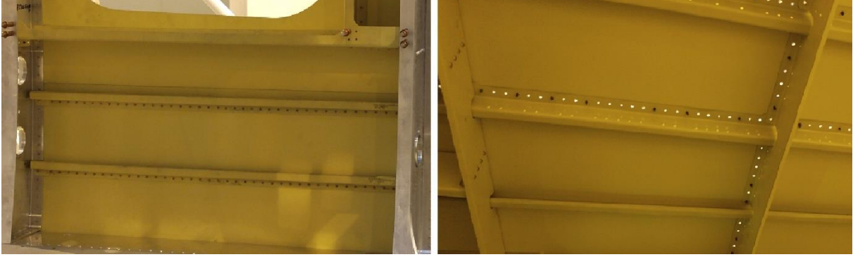
Şekil 1. Helikopter gövdesi takviyeli kabuk yapısı (solda) ve kuyruk bölgesi takviyeli kabuk yapısı (sağda)
