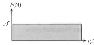
Şekil 2. Konsol helisin B ucundan uygulanan birim adım fonksiyonu yükleme
