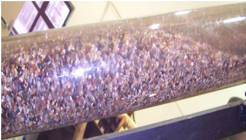
Şekil 1 Kesinti taşınım deneyi esnasında deney düzeneği kesiti
