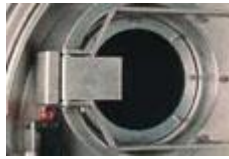
Şekil 4.3. Yıkama makinası numune kapağı detayı
