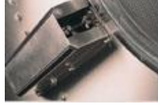
Şekil 4.5. Yıkama makinasındaki pnömatik kapak kilidi
