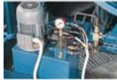
Şekil 4.6. Yıkama makinasındaki hidrolik santral ünitesi
