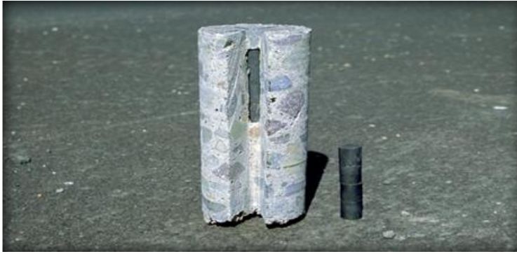
Şekil 3.24: Yol kaplamasına yerleştirilen manyetik çubuklar.
