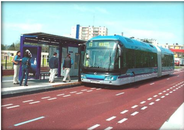
Şekil 3.25: Optik istasyona hassas yanaşma sistemi, Rouen – Fransa.
