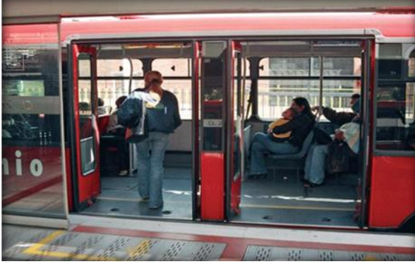
Şekil 3.12: Taşıt zemini ile aynı yükseklikte platform, Kolombiya – Bogota.
