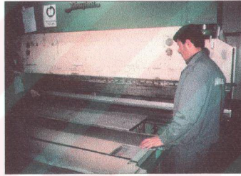
Fotoğraf 3.2: Yangın kesici çeliğin fabrikada bükülmesi
