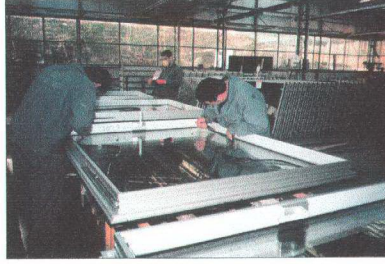
Fotoğraf 2.5: Taşıyıcı bileşen ile cam arasına fitil yerleştirilmesi
