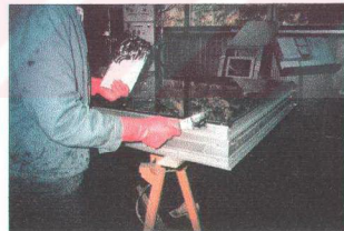
Fotoğraf 2.3: Silikonlama işleminden sonra taşma yapan silikonun alınması
