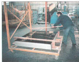
Fotoğraf 2.4: Silikonlama işleminden sonra cam ünitelerin taşınak üzere istiflenmesi
