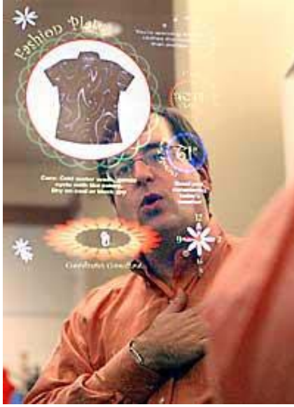
Şekil 3.26: aynadaki gizli oled ekran ( http://www.microsoft.com , 14.03.2007)
