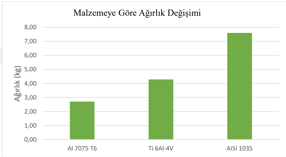
Şekil 5.66: Tork bağlantıları için malzemeye göre ağırlık grafiği.
