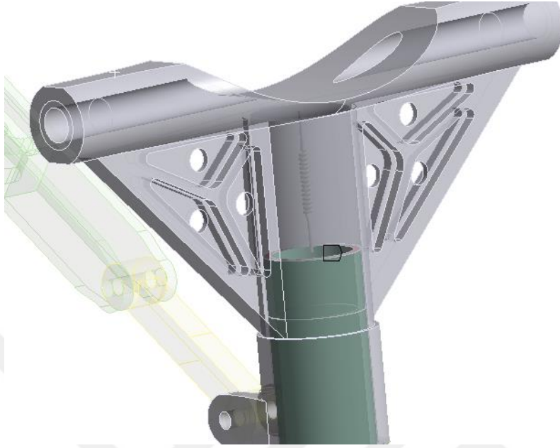
Şekil 5.22: Ana dikme ile piston bağlantısı -2.
