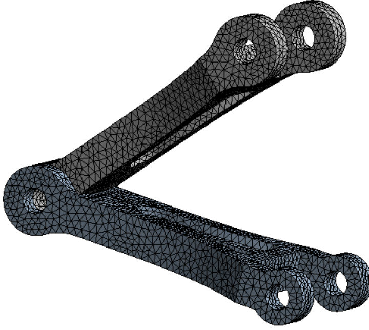
Şekil 5.9: Tork bağlantıları ağ yapısı.
