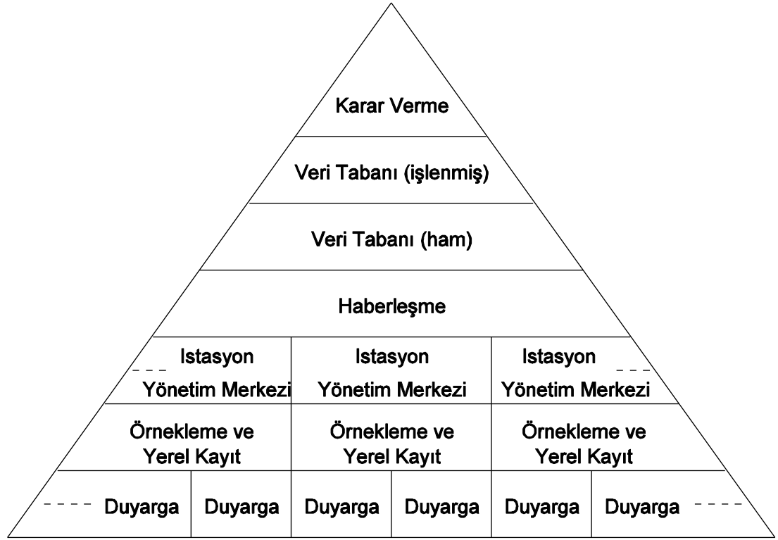
Şekil 1.3 GLiVET sisteminin genel katmanlı yapısı
