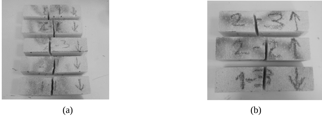
Şekil 4.12: Eğilmede çekme dayanımı tayini deneyi sonrası (a) G3 ve (b) G4 numunelerin durumu.
