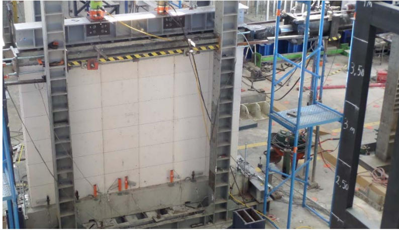
Şekil 5.8: Taşıyıcı duvar deneyi düzeneği.
