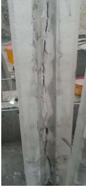
Şekil 4.38: Deney sonrası duvar panellerinde oluşan çatlaklar.
