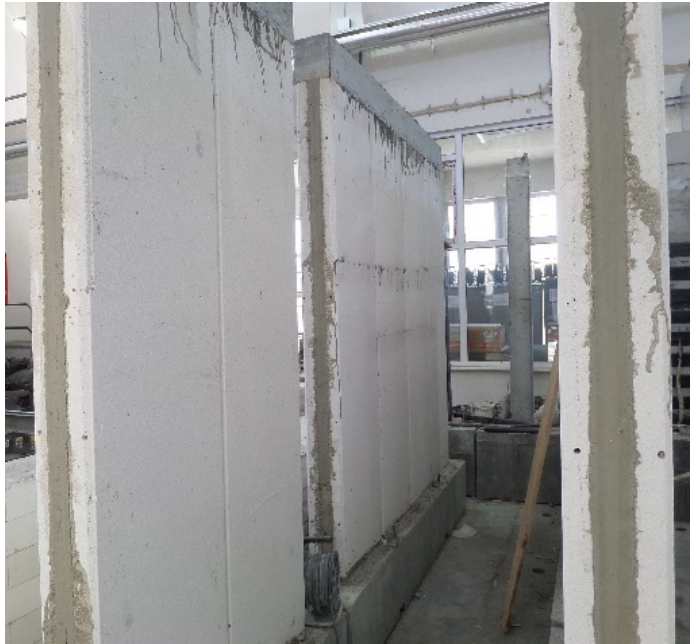
Şekil 5.6: Taşıyıcı duvar deneylerinde kullanılacak numuneler.
