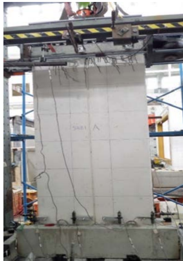
Şekil 5.13: SW-2-1 numunesi deney öncesi görünümü.
