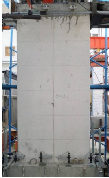
Şekil 5.24: SW-2-2 numunesi deney öncesi görünümü.
