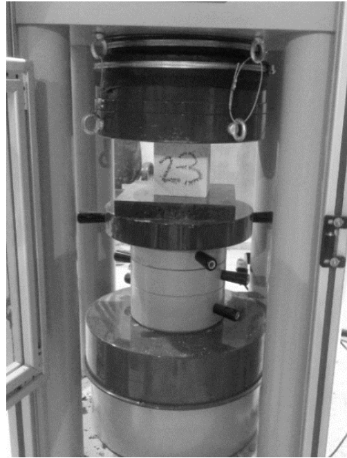
Şekil 4.3: Gazbeton basınç dayanım tayini deney düzeneği.
