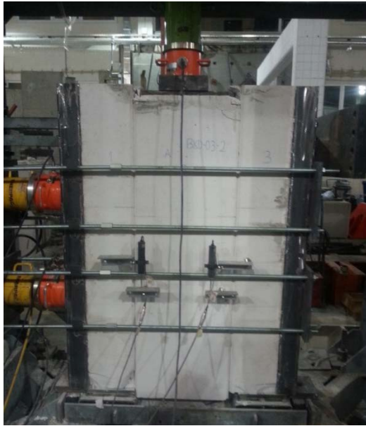
Şekil 4.36: Gazbeton döşeme panellerinin deney sonrası görünümü.
