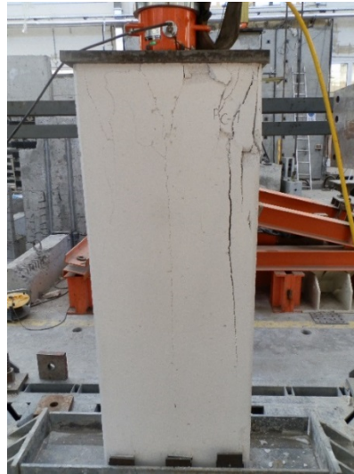
Şekil 4.25: Duvar basınç deneyi sonrasında numunenin görüntüsü.
