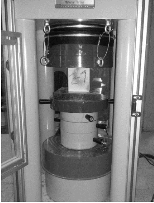
Şekil 4.3: Gazbeton basınç dayanım tayini deney düzeneği.
