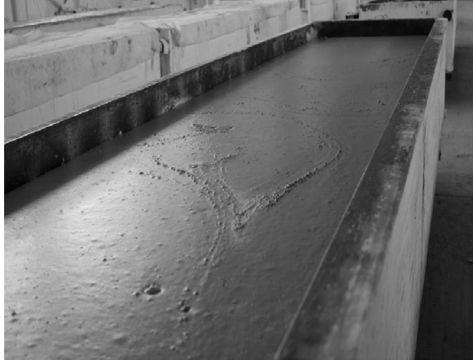
Şekil 2.2: Çelik kaplara dökülen gazbeton karışımının kabarması.
