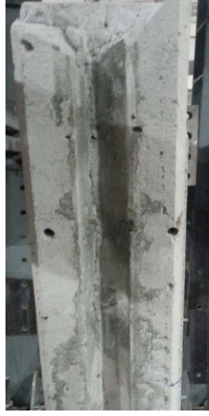
Şekil 4.38: Deney sonrası duvar panellerinde oluşan çatlaklar.
