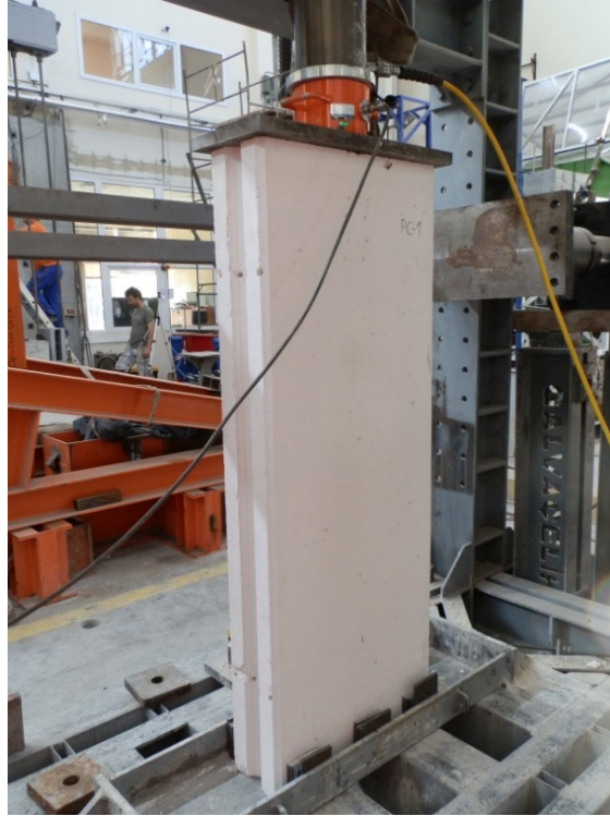
Şekil 4.24: Donatılı panel duvar basınç deneyi düzeneği.
