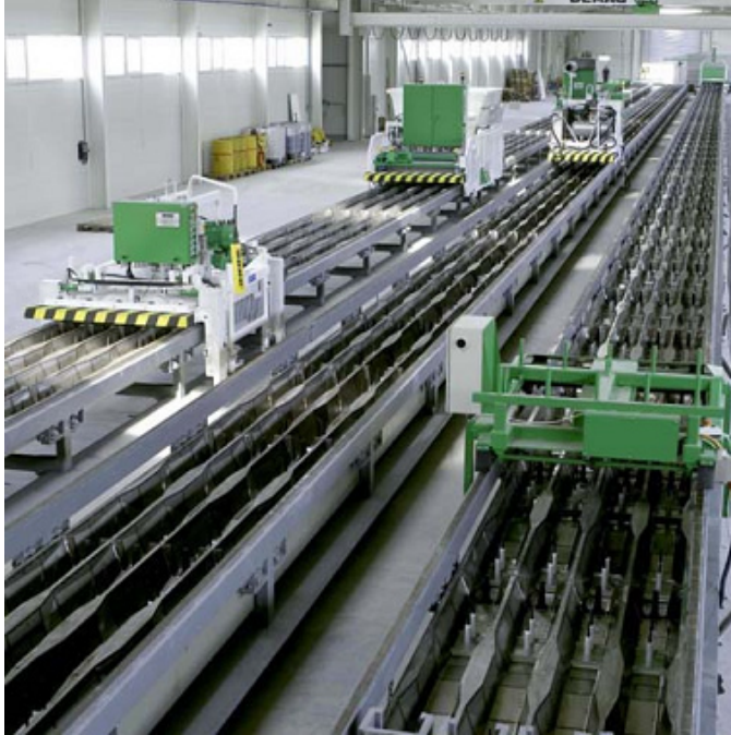
Şekil 3.14 : Uzun sıra beton travers üretimi (Abetong travers fabrikası).
