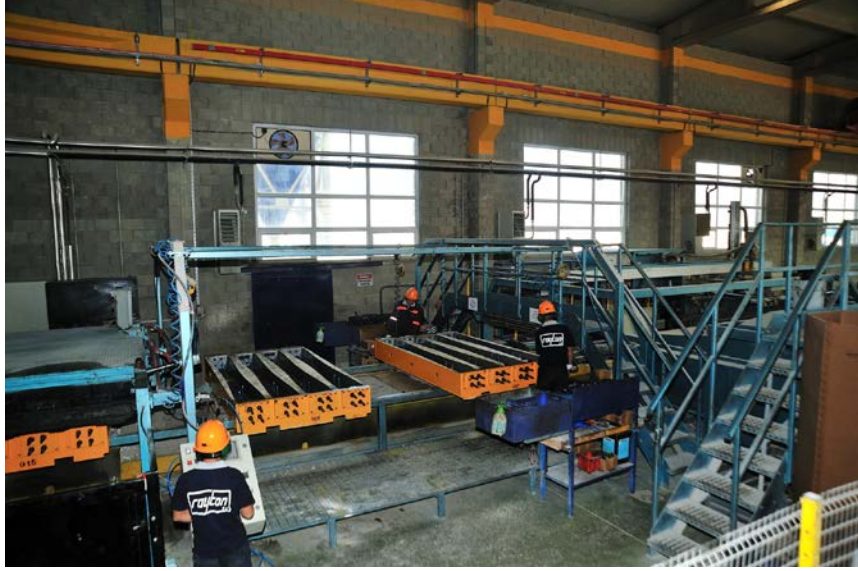
Şekil 3.15 : Döner pres travers üretimi (Rayton Travers Fabrikası, Afyon).
