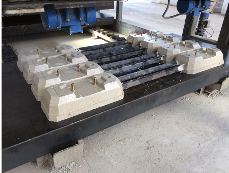
Şekil 2.4 : TW120 tipi ikiz beton travers.
