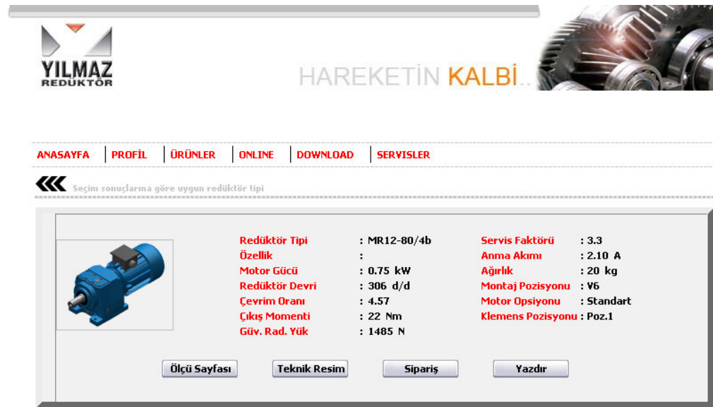
Şekil 6.3 : Seçilen motor akuple redüktörün teknik özellikleri
