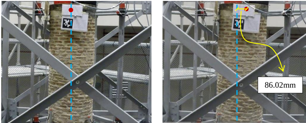
Şekil 10. “0.3g” ivme altında minare tepesinde kuzey-güney doğrultusunda meydana gelen yerdeğiştirme
