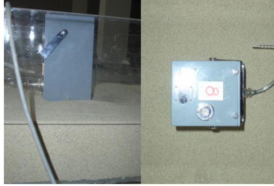
Şekil 4.16. Mikrotremor cihazı ile zeminin serbest titreşiminin ölçümü
