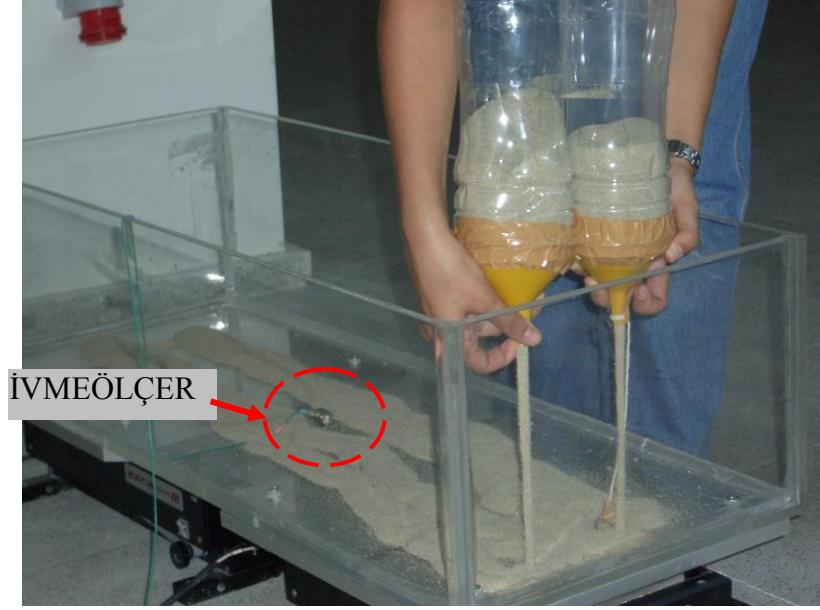
Şekil 4.15. Yağmurlama ile numunenin serilmesi ve ivmeölçerlerin yerleştirilmesi
