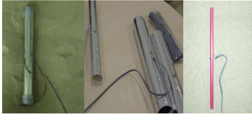
Şekil 4.22. Çelik, karton-folyo, pipet borular üzerine yapıştırılmış strain-gaugeler
