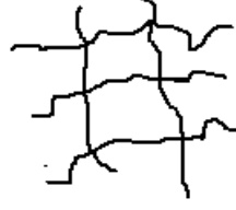
Şekil 2.10. Bir hidrojinin çapraz bağı ağ yapısı
