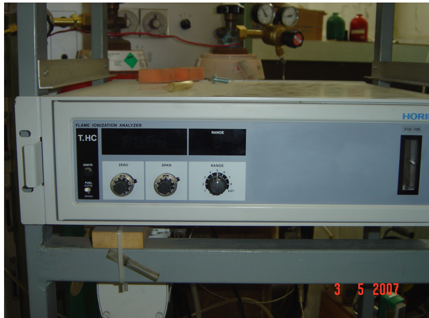
Şekil 6. 7: Kızdırıcılı hatlı HC analizörü
