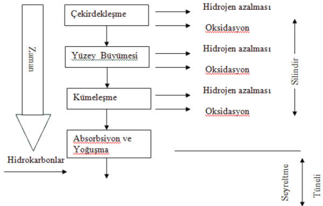
Şekil 4. 9 Silindir içerisindeki partikül oluşumunun şematik gösterilişi
