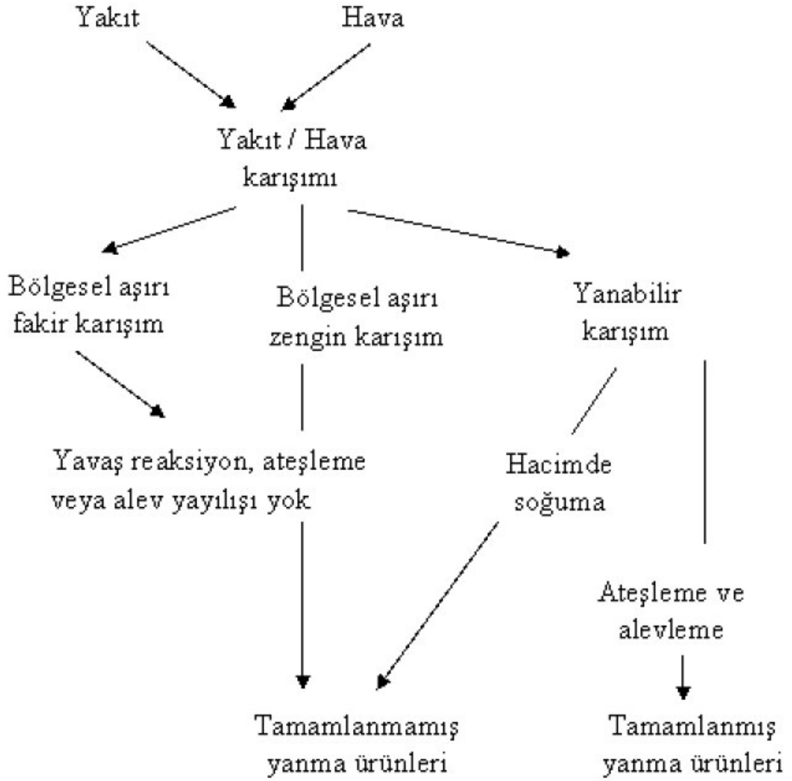
Şekil 4. 1: Tutuşma gecikmesi peryodunda püskürtülen yakıtın HC mekanizmasının şematik görünüşü
