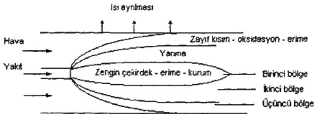
Şekil 4. 10: Türbülans yayılmalı alevde kurumun oluşumu ve oksidasyonu
