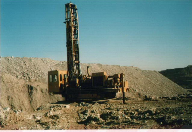
Şekil 3.7. GLİ/36 Pano'da Kullanılan Döner(Rotary) Ingersoll-Rand Marka Bir Delici.
