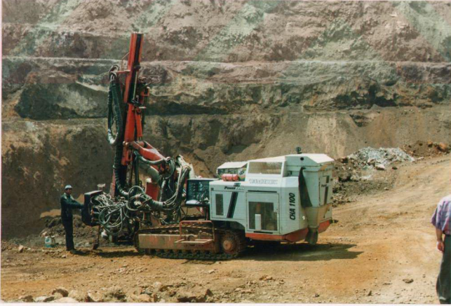
Şeki 3.2. Özkoyuncu Madencilik'in Yahyalı Şantiyesinde Kullanılan Yerüstünden Darbeli Tamrock Marka Bir Delici.
