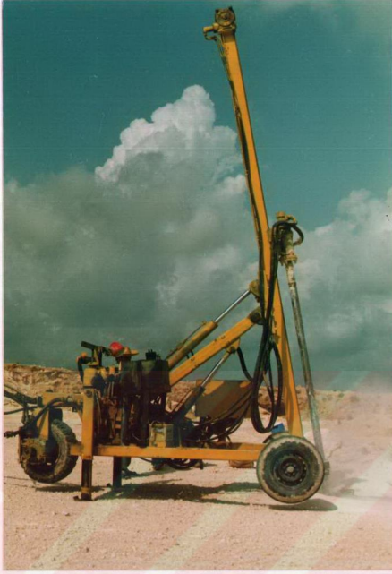
Şekil 3.5. Adana Çimento'nun Adana Şantiyesinde Kullanılan Delik Dibinden Darbeli Gemsa Marka Bir Delici.
