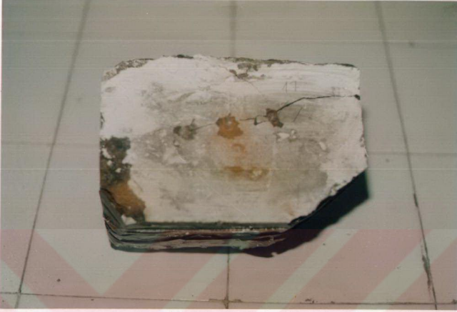
Şekil 6.6. Chip Oluşumu Veren Deney Numunesi Örneği.
