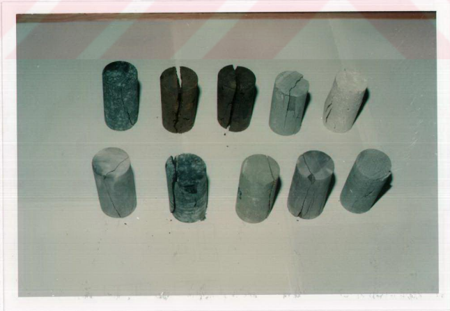
Şekil 5.2. Tek Eksenli Basınc Deneyinde Kırılan Numuneler.
