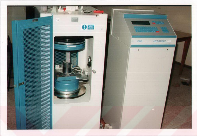
Şekil 5.1. Tek Eksenli Basınc ve Çekme Deneylerinin Yapıldığı Pres.
