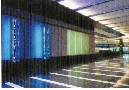
Şekil 5.20. LEDler, fiberoptik kablolar ve dikroik camlardan oluşan bir lobi yerleştirmesi
