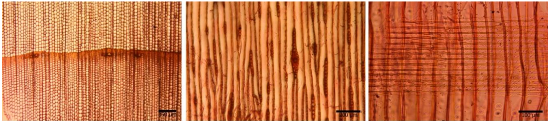
Şekil 4.28 : Ahşap çita örneğinin enine, teğet ve radyal kesitlerinin mikroskobik görüntüsü.
