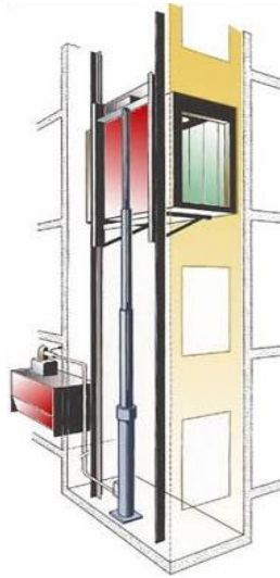
Şekil 2.2 : Yandan Doğrudan Tahrikli Tek Pistonlu Hidrolik Asansör
