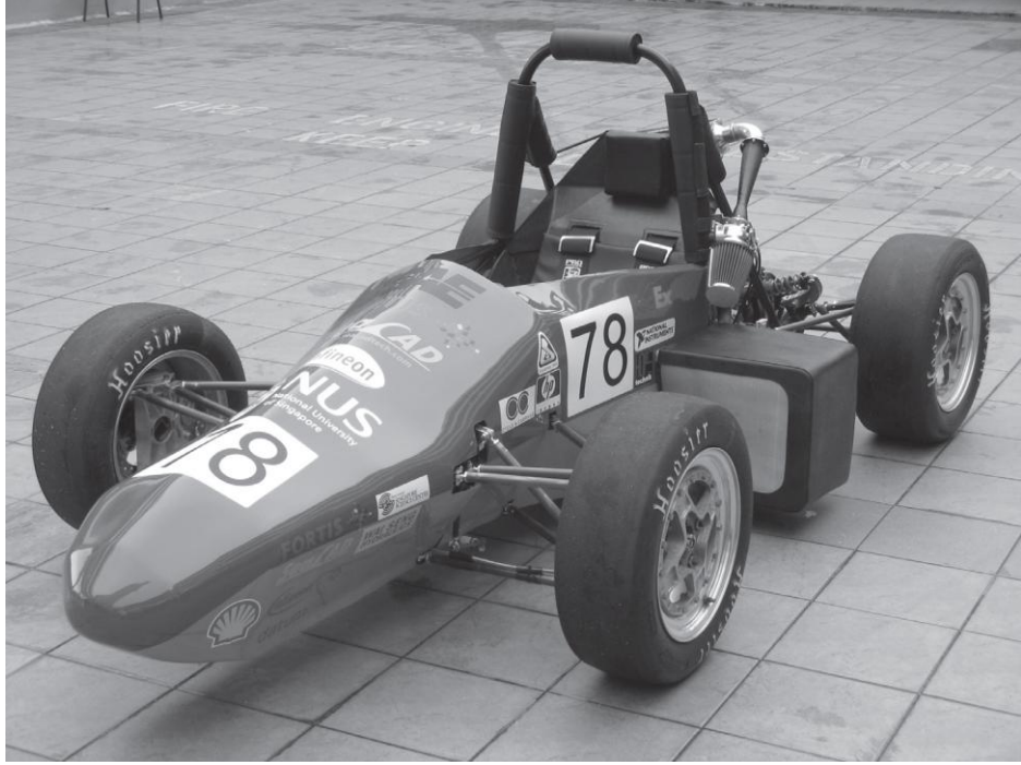
Şekil 2.1 : Dingilleri magnezyum alaşımı olan NUS-F SAE aracı [2].
