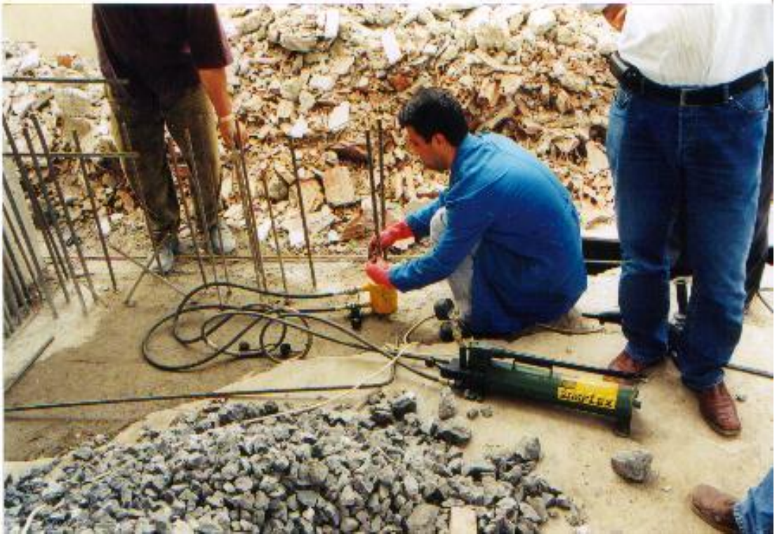
Şekil 8.15 Epoksili Ankrajlara Uygulanan Çekme Deneyi
