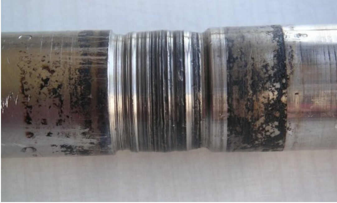
Şekil 3.1: Bir mil yüzeyinde abrazyon sonucu oluşan aşınma [15].
