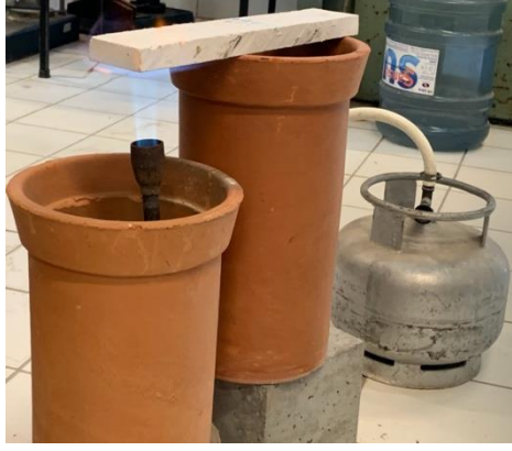
Şekil 4. Noktasal alev altında ölçüm düzeneği
