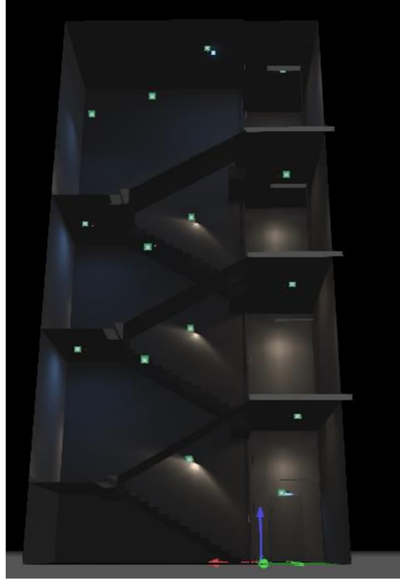
Şekil 14. Mafsal 5 Yangın Merdiveni Dilaux Evo Benzetim Görseli
