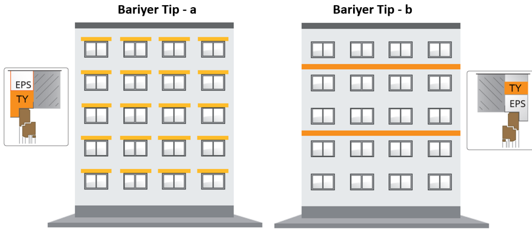
Şekil 6: Yangın bariyeri alternatifleri (yalıtım kalınlığı 10cm'nin üzerinde 30cm'nin altında ise)
