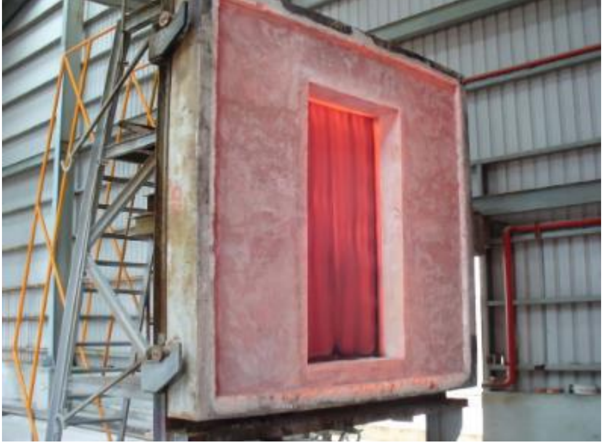
Şekil 2: Asansör kapısı yüksek sıcaklık testi (C.-C. Lai and Lin 2017)
