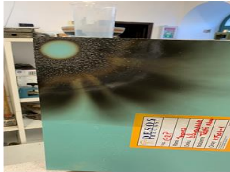
Şekil 8. Alev kaynağı uygulanmış yüzeyde oluşan damlama durumu
