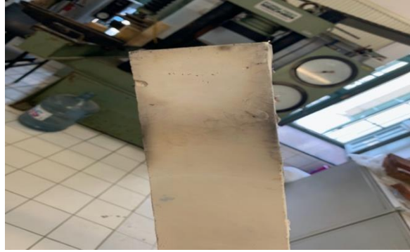
Şekil 5. Alev kaynağı uygulanmış yüzeyde oluşan damlama durumu
