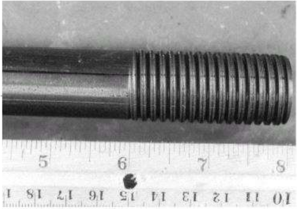
Şekil 4.2 Ovalama sonrasında örnek iş parçasındaki çizgilerin durumu [1].
