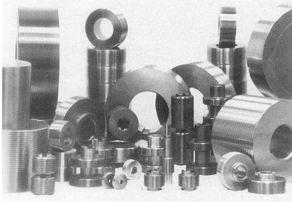
Şekil 2.17. Vida ovalama yönteminde kullanılan silindirik takımlara örnekler [13].
