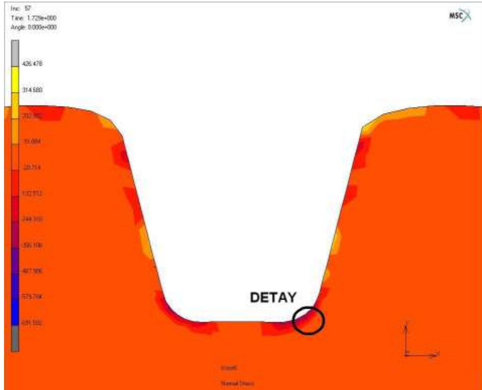
Şekil 5.12 Ovala m a s i m ũ l a s y o n u s o n r a s ı n d a d ı ŝ p r o f i l i n d e o l u ŝ a n g e r i l n e d a ğ l ı m .
