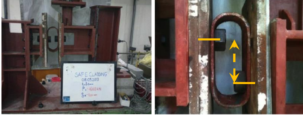
Şekil 2.5 : İ.T.Ü Laboratuvarında yapılan çelik yastık testlerinden bir örnek (Sol) ve kesme kuvveti altında deformasyona uğramış cushion (Sağ). (Smyrou 2014, Özkaynak 2014).
