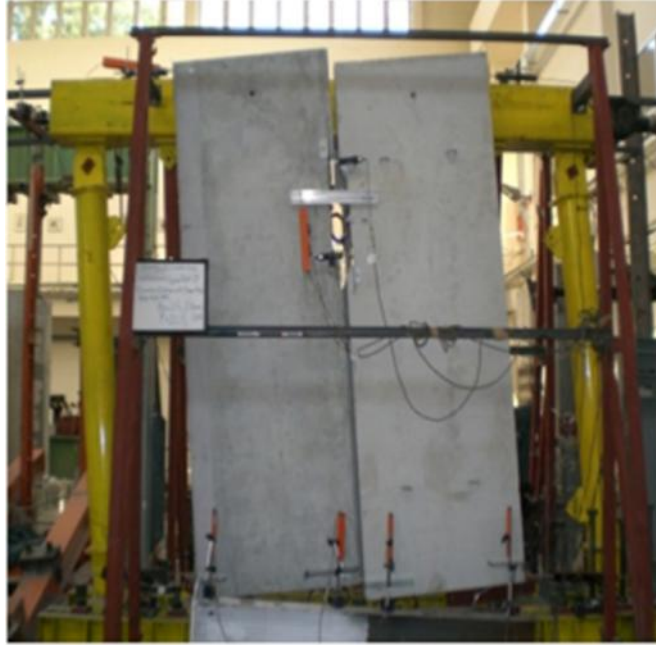
Şekil 2.6 : Her panel tek yastıkla yukarıdan kirişe, çift yastıkla aşağıdan zemine ve ayrıca tek çelik yastıkla diğer panele bağlanmıştır (SAFECLADDING projesi İ.T.Ü. ekibi çalışmalarından alınmıştır).
