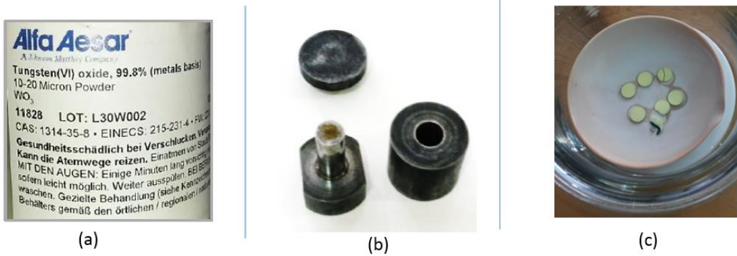
Şekil 2.1 : (a) Tungsten oksit tozu, (b) pelet hazırlanışında kullanılan sistem ve (c) hazırlanan peletlerin fotoğrafı.
