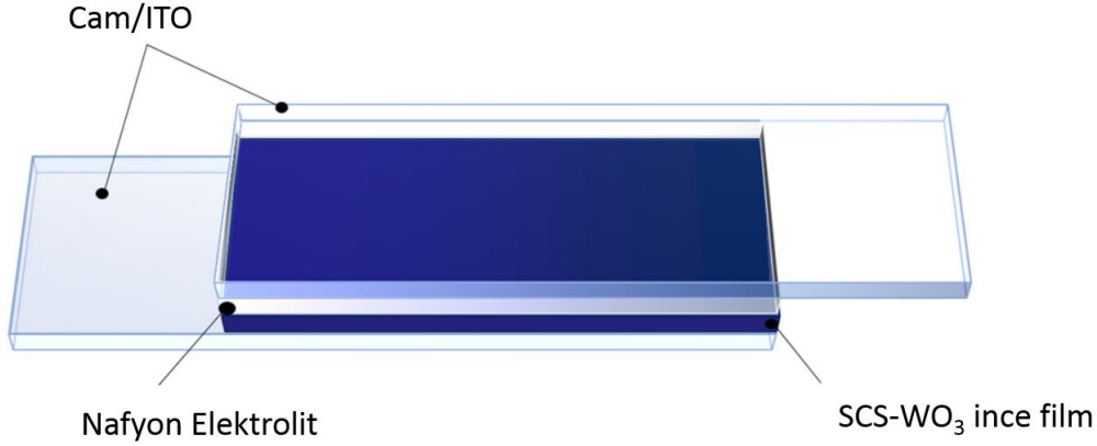
Şekil 2.43 : Tüm katmanları katı ECD'nin şematik gösterimi (Cam/ITO/SCS-WO 3 /Nafyon/ITO/Cam).
