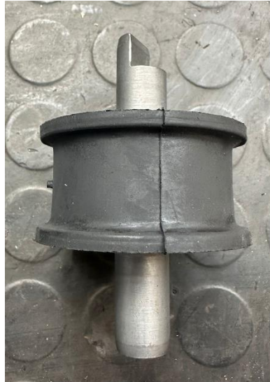
Şekil 3.5: Üretimden çıkan ömür testi test takozu.
