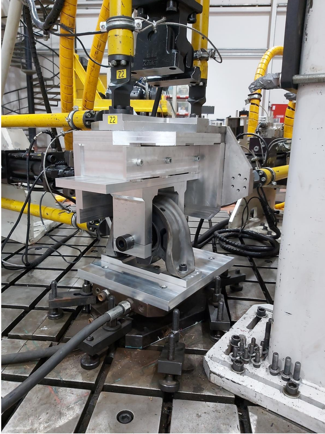
Şekil 4.5: Ömür testi için montajlanmış şaft askı lastiği.
