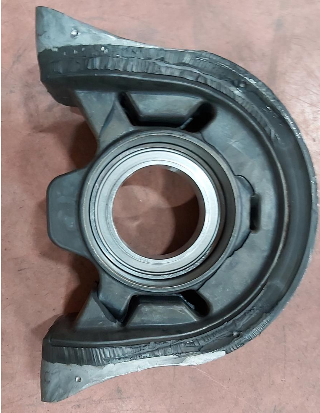
Şekil 4.6: Ömür testini kopma sonucu tamamlayan numune.
