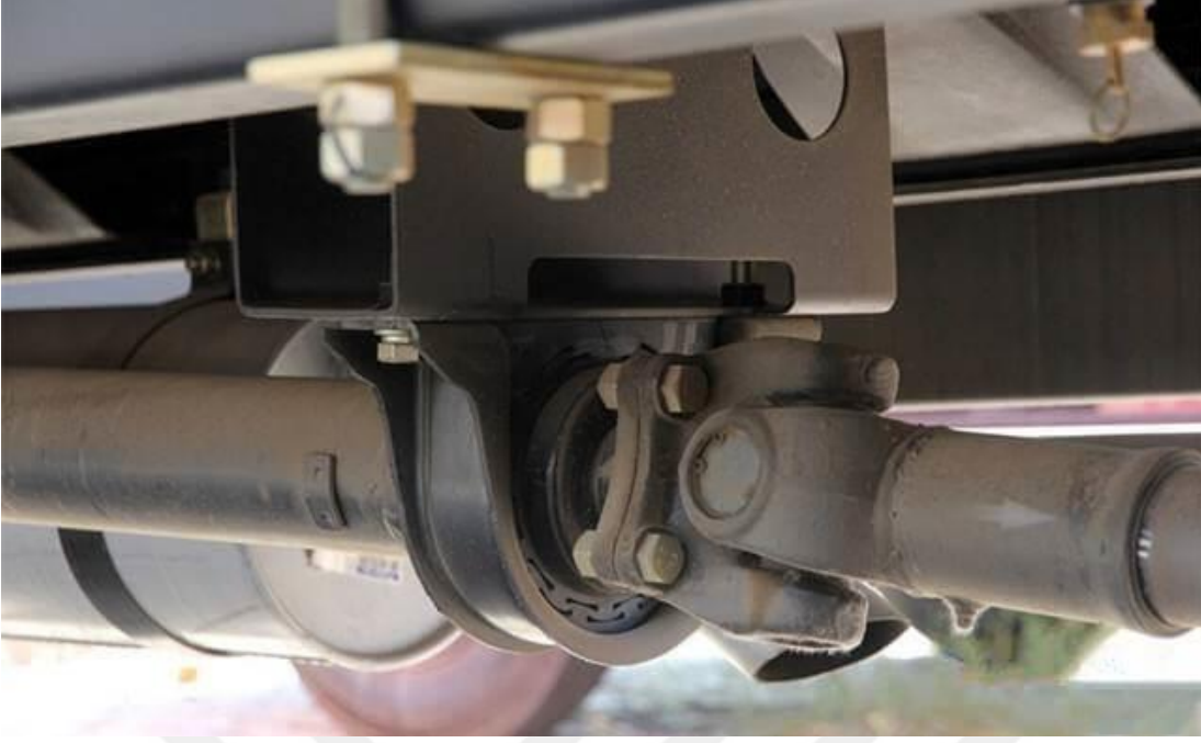
Şekil 1.2: Kardan miline bağlı şaft askı lastiği.
