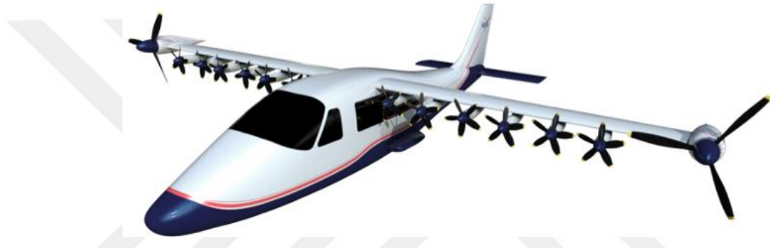
Şekil 1.1: Kanat ucundaki motorları ile dönme çarpınmasını yeniden gündeme getiren DEP konsepti, X-57 Maxwell uçağı, Deere ve diğ. (2017)'den uyarlanmıştır.
