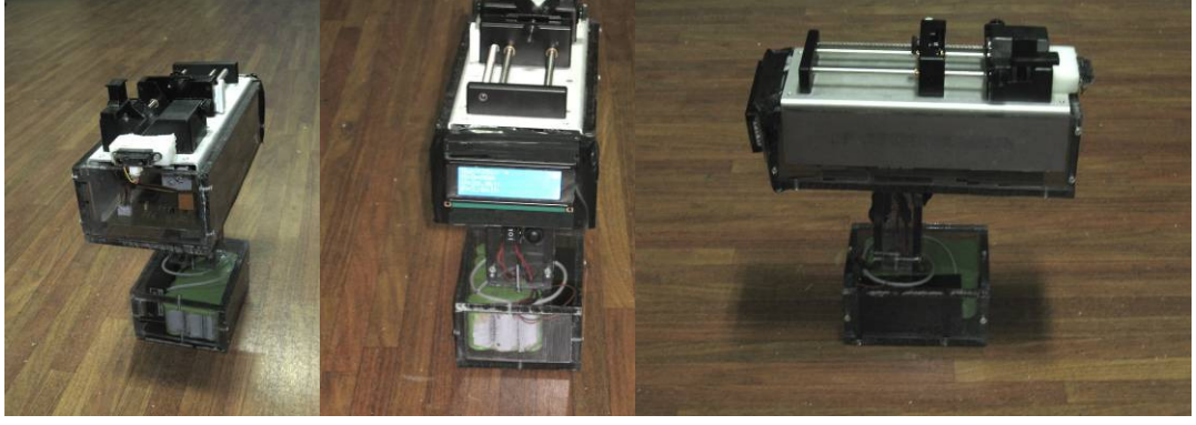
Şekil 2.21 : Parçaların pleksiglastan bir yapının içine yerleştirilmesi ile imal edilen ikinci prototip
