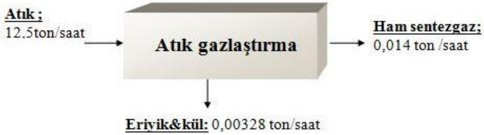
Şekil 5.12 : Gazlaştırma sisteminde oluşan kütle dengesi
