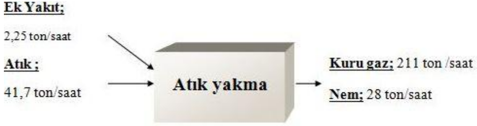
Şekil 5.2 : Ek yakıt ilavesi ile birlikte sistemde kütle dengesi
