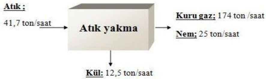
Şekil 5.1 : Yakma sisteminde oluşan kütle dengesi
