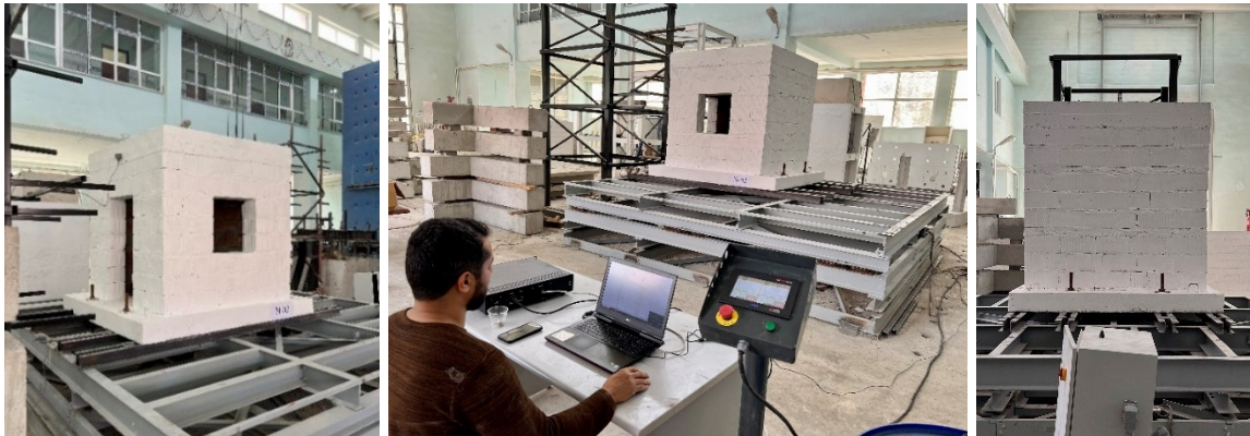
Şekil 7. Donatılı yığma yapı numunesinin deneysel kurulumu
