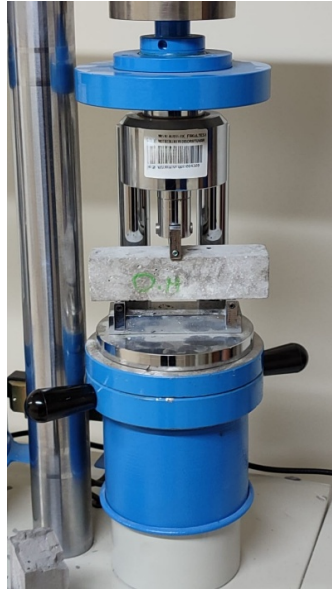
Şekil 11. TS EN 12390-5 eğilme dayanımı testi
