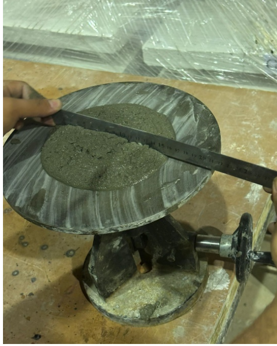
Şekil 3. Standart karışım için ASTM-C1437 Yayılma Tablası Testi
