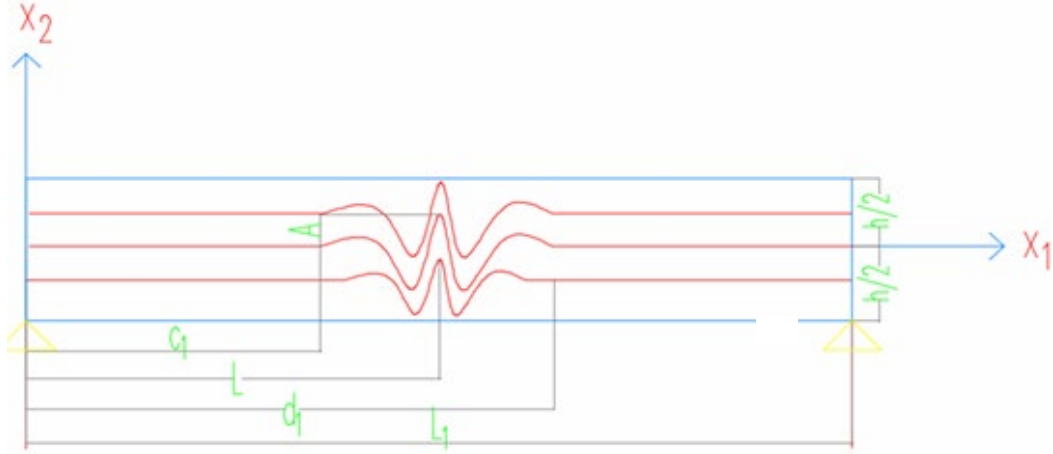
Şekil 2. Plak kesiti ve yerel eğriliği tanımlayan geometrik parametreler
