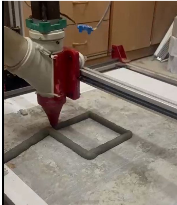
Şekil 4. Ekstrüde edilebilirlik şartının sağlandığı karışım örneği
