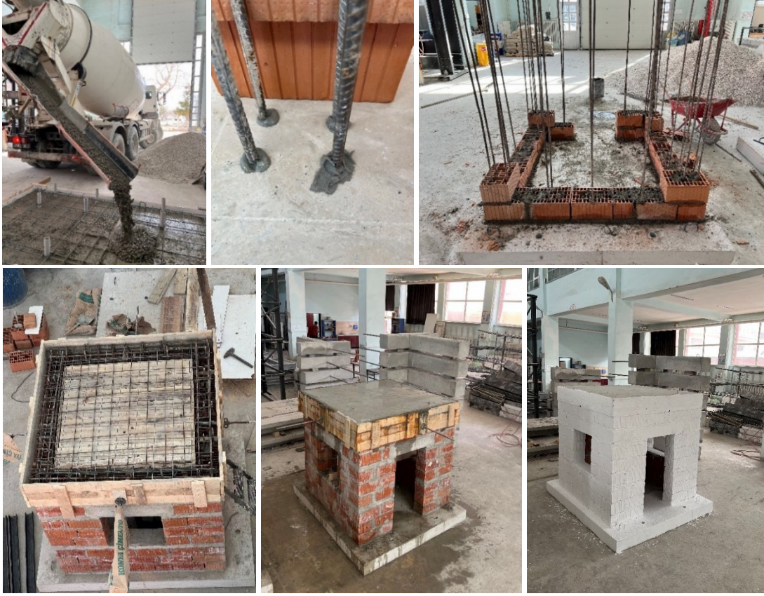
Şekil 4. Donatılı yığma yapı numunesinin üretim aşamaları
