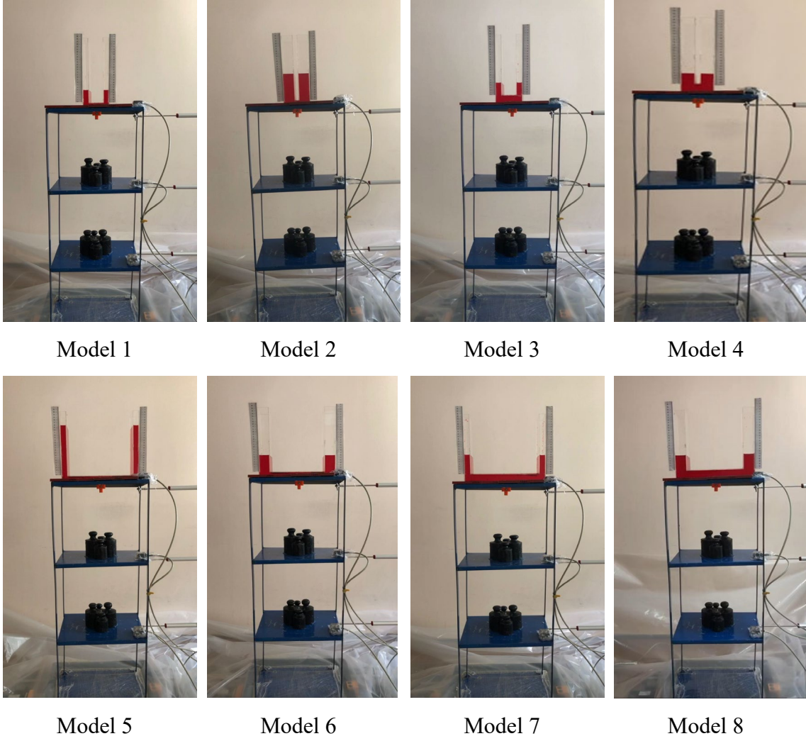
Şekil 5. Tasarlanan laboratuvar ortamındaki yapı-TLCD model deney düzeneği
