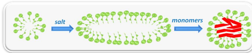
Şekil 5.13 : SDS çözeltisindeki küresel misellerin tuzun katılması ile solucan tipi misellere dönüşerek boyutunu büyütmesinin ve hidrofobik monomerin eklenmesi sonucu büyüyen boyutunu değiştirmeden tekrar küresel şekline dönmesinin şematik gösterimi
