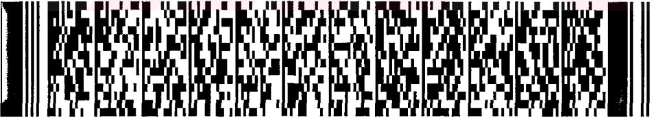
Şekil 3.11. PDF 417 Barkodu. Çözünürlük; 20 mil, Eleman yüksekliği; 60 mil, Güvenlik seviyesi; 4, Veri kolon sayısı; 10
