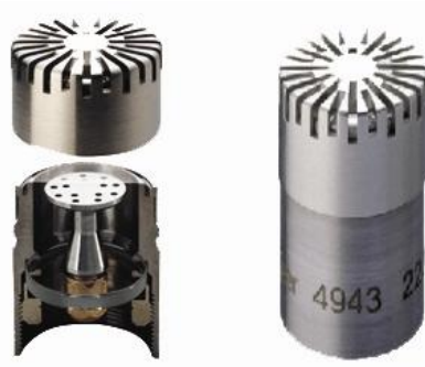
Şekil 4.1 : Mikrofonların iç ve dış yapısı [29]
