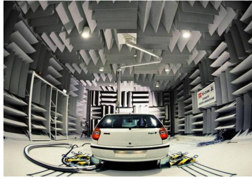
Şekil 2.6 : İTÜ-Otam'da bulunan yari anekoik oda
