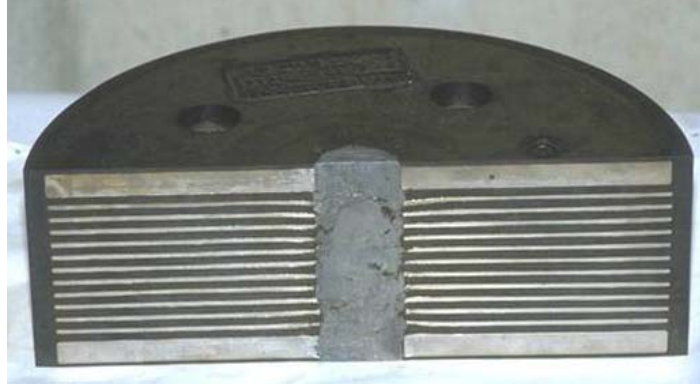
Şekil 2.7 : Kurşun çekirdekli elastomer yalıtıcı (Constantinou and Whittaker, 2004)
