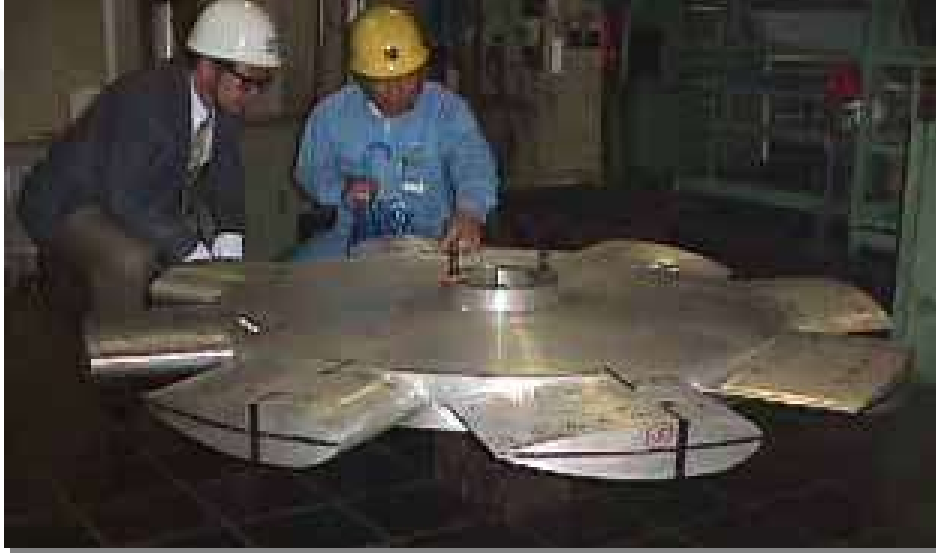
Şekil 2.19 : JAMSTEC araştırma merkezinin ürettiği Wells türbininin rotoru [29].
