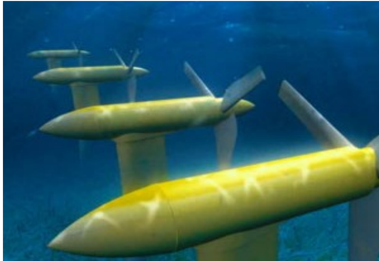
Şekil 2.7 : Akıntı türbini tarlası [13].
