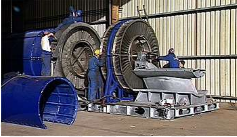
Şekil 2.24 : 500kW'lık LIMPET türbininin üretim safhasından bir görüntü.
