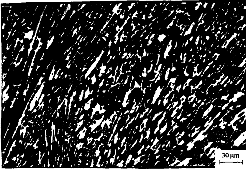
ŞEKİL: 7.11. 1000°C'de 2 Saat Ostenitleme Yapılıp Havada Su Verilen Örnek No 11'nin Mikroyapısı
