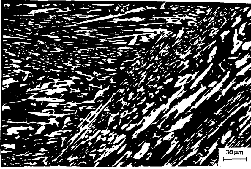
ŞEKİL: 7.13. 1000°C'de 2 Saat Ostenitleme Yapılıp Fırında Su Verilen Örnek No 13'nün Mikroyapısı
