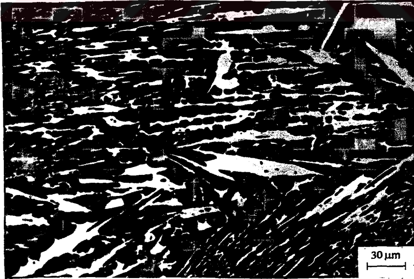
ŞEKİL: 7.20. 1000°C'de 4 Saat Ostenitleme Yapılıp Havada Soğutulduktan Sonra 250°C'de 4 Saat Temperleme Yapılan Örnek No 20'nin Mikroyapısı
