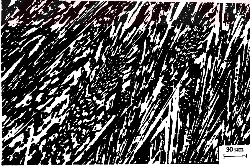
ŞEKİL: 7.14. 1000°C'de 2 Saat Ostenitleme Yapılıp Yağda Su Verilen Örnek No 14'nün Mikroyapısı
