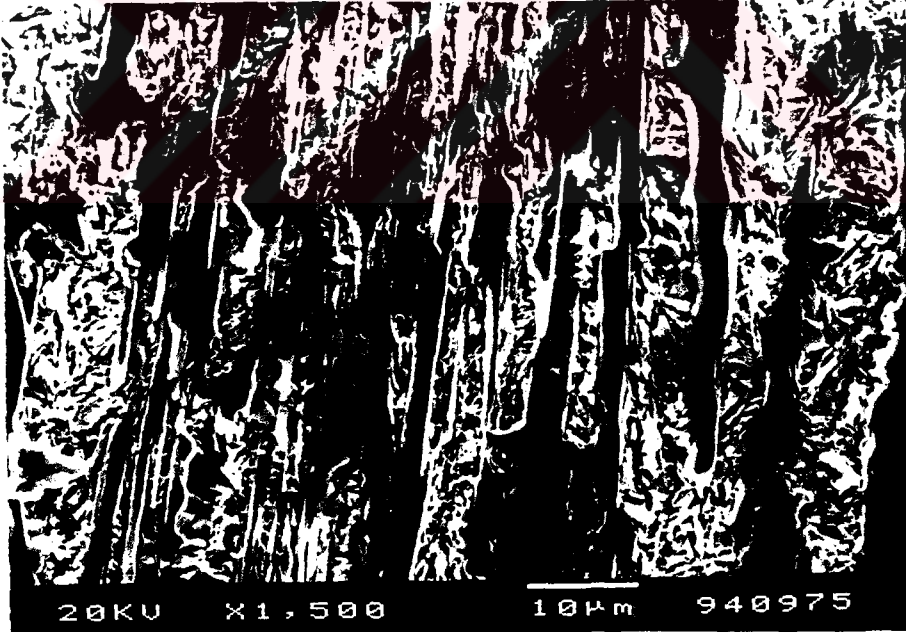
ŞEKİL: 7.32.f- 1000°C'de 4 Saat Ostenitleme Yapılıp Havada Soğutulduktan Sonra 450°C'de 4 Saat Temperleme Yapılan Örnek No 24'ün Mikroyapısı
