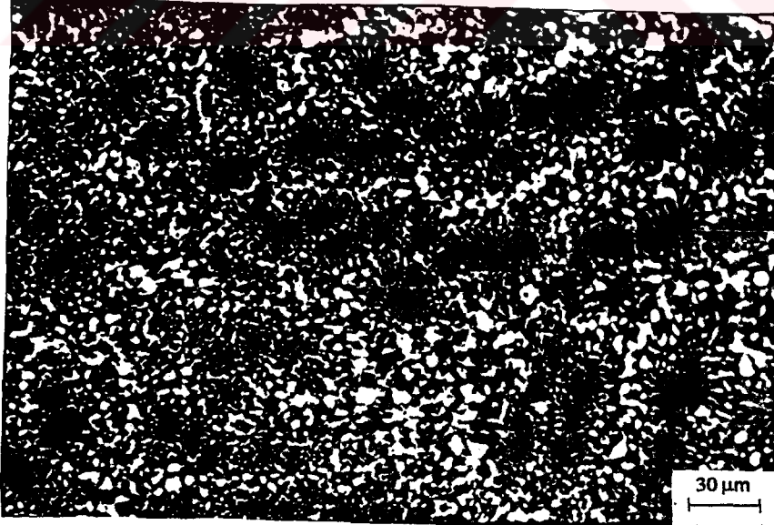
ŞEKİL: 7.18. 1000°C'de 4 Saat Ostenitleme Yapılıp Havada Su Verilen Örnek No 18'nin Mikroyapısı
