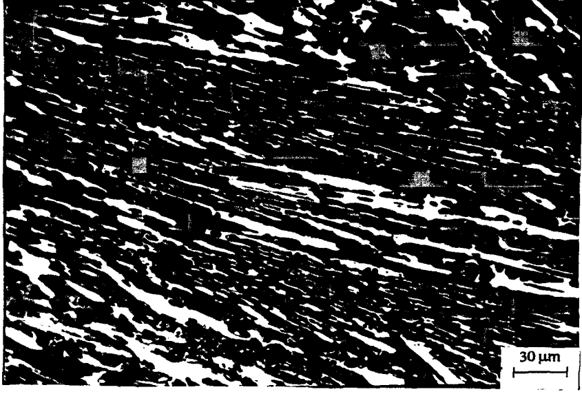
ŞEKİL: 7.19. 1000°C'de 4 Saat Ostenitleme Yapılıp Havada Soğutulduktan Sonra 200°C'de 4 Saat Temperleme Yapılan Örnek No 19'nun Mikroyapısı
