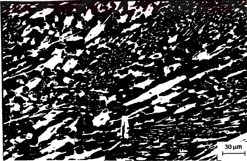
ŞEKİL: 7.16. 1000°C'de 3 Saat Ostenitleme Yapılıp Fırında Su Verilen Örnek No 16'nın Mikroyapısı
