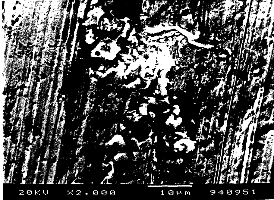
ŞEKİL: 7.50. Örnek NO: 18'in Yüzeyinde Oluşan Hasar
