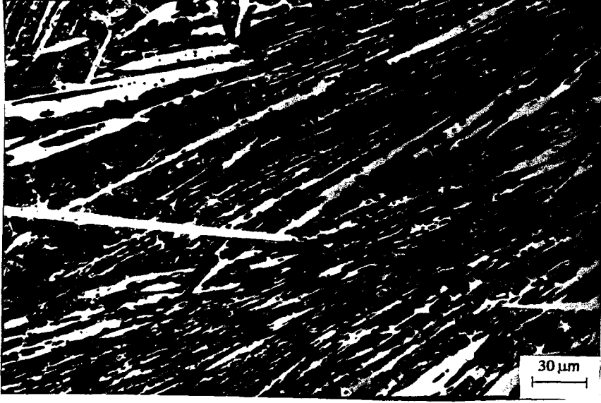
ŞEKİL: 7.23. 1000°C'de 4 Saat Ostenitleme Yapılıp Havada Soğutulduktan Sonra 400°C'de 4 Saat Temperleme Yapılan Örnek No 23'nün Mikroyapısı
